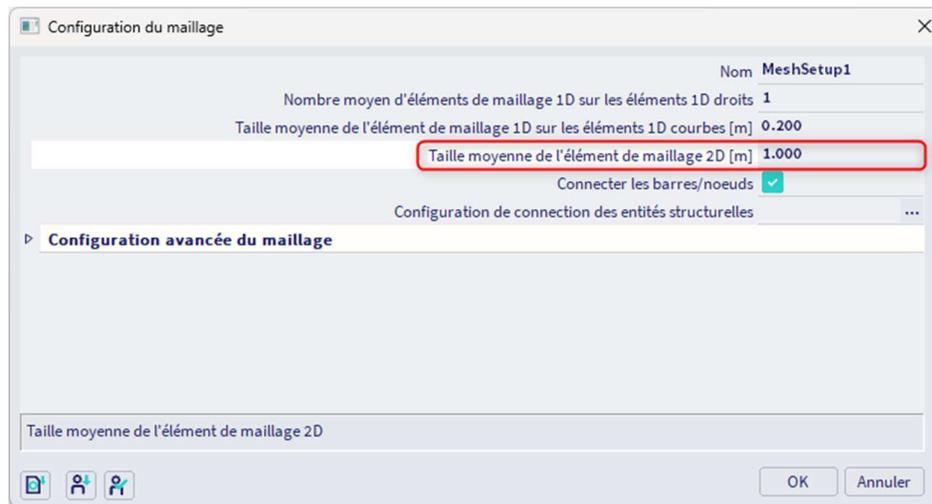
La taille de maille peut également être modifiée dans la fenêtre d'analyse EF avant le lancement du calcul :
