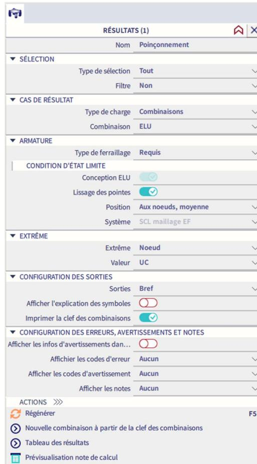
Définir le type de sélection sur « Tout », le type de charge sur « Combinaisons ELU » et le type de ferrailage sur « Requis ».
